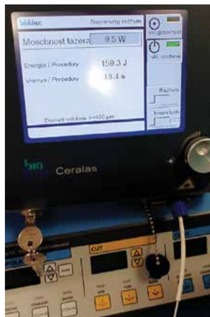
Рис. 1. Энергетическая установка с выбранными параметрами работы Fig. 1. Laser ablation system with working parameters set
